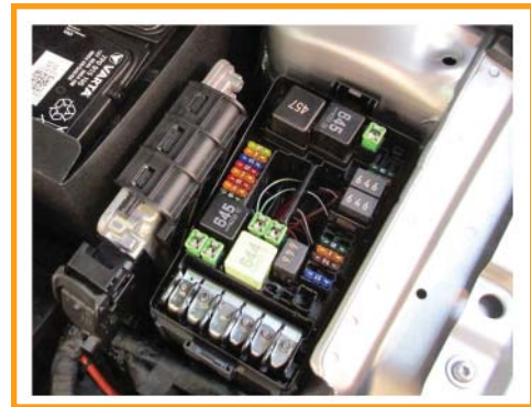
Electrical Box with SA and SB
